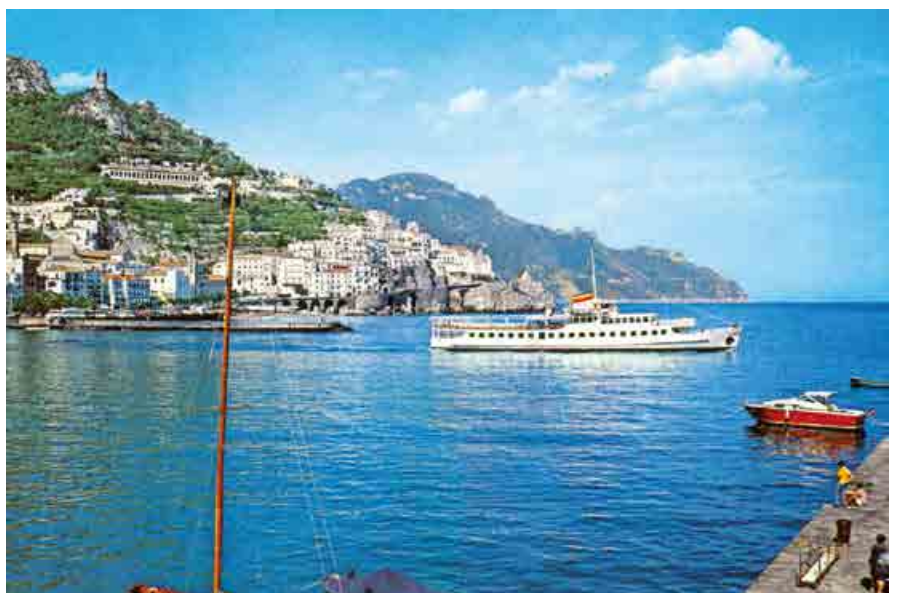
La Città di Abbazia in uscita da Amalfi negli anni sessanta, dopo essere stata rimodernata; si notano alcune modifiche tra cui la chiusura con finestrate delle passeggiate del ponte di coperta
