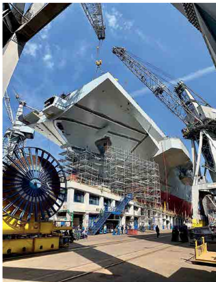
Sezioni prodiera del ponte di volo nelle fasi finali di costruzione
