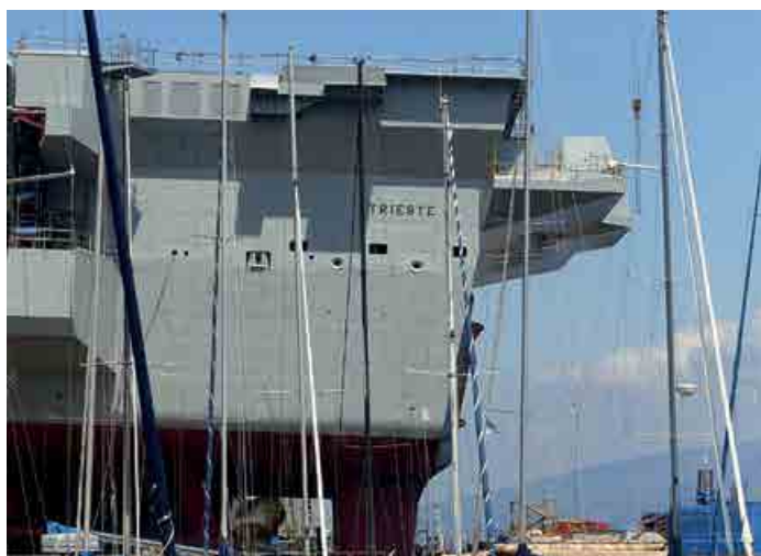
Sezioni prodiera del ponte di volo nelle fasi finali di costruzione
